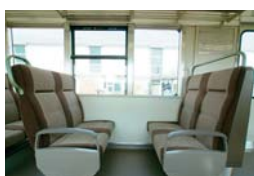
車両設計時には、使用から廃棄までのライフサイクル全体に配慮しています(P46参照)。車体や車輪などはほとんどリサイクルされますが、リサイクル率をさらに高めるため、新型車両導入時には、車両の腰掛掛物を従来のウレタン系の材質から、リサイクル可能なポリエステル系の材質に変更しています。
